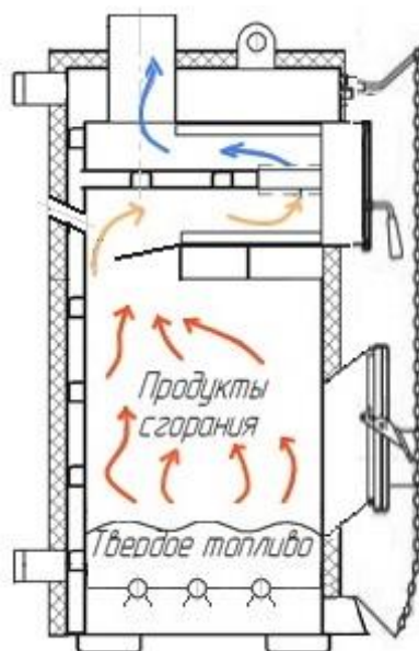
Рисунок 1 - Принципиальная схема двухступенчатого сжигания биоотходов
