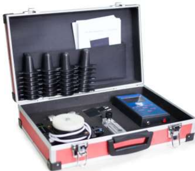
Рисунок 1 – Загальний вигляд тестера доїльних установок
